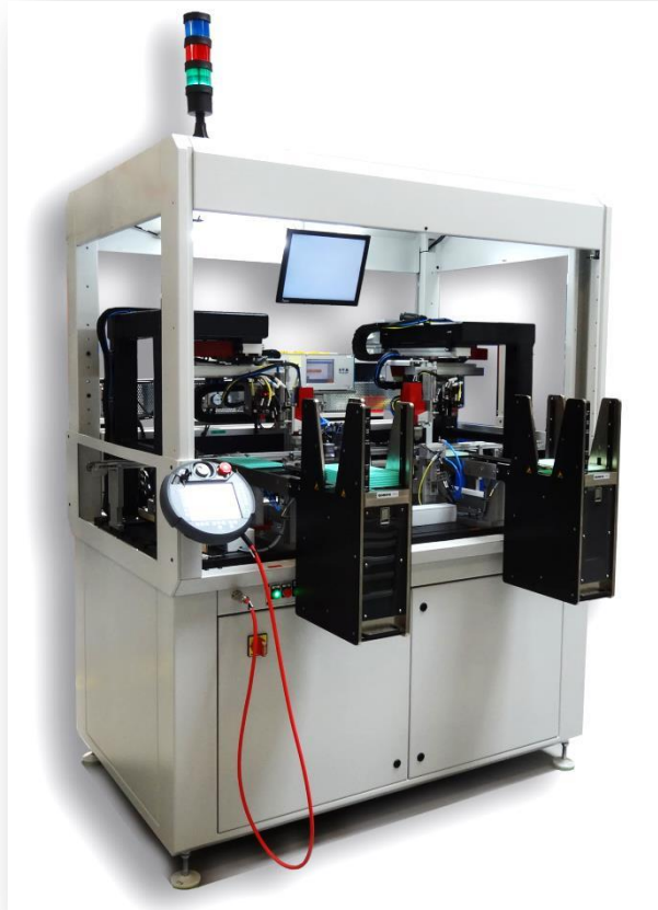
Cellule d'assemblage et de palettisation
